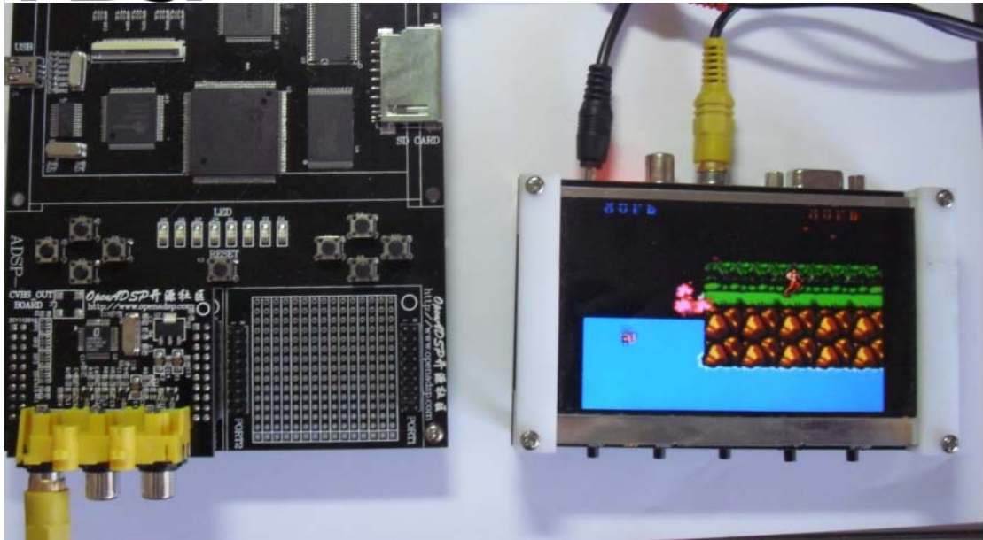
ADSP-EDU-BF53X 开发板通过 CH7024 子卡板模块输出游戏图像，由视频显示子卡板显示。
