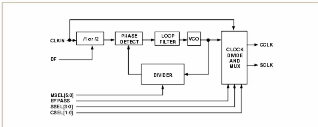
输入时钟送给 ADSP-BF51x 后，通过 DF 设置是否对输入时钟分频，然后将根据 MSEL 的值对时钟进行倍频，倍频后将时钟送给 VCO，由 VCO 根据设置的分频系数，分出内核时钟和系统时钟。
